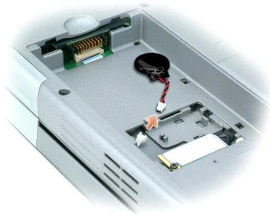
5. Conecte la nueva batería de celda del espesor de una moneda al enchufe.
