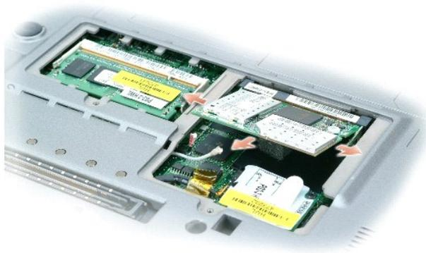
➡ **AVISO:** los conectores tienen la forma adecuada para garantizar que la inserción es correcta. Si nota resistencia, compruebe los conectores y vuelva a alinear la tarjeta.
