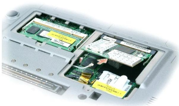
5. Conecte los cables de antena a la minitarjeta PCI.
